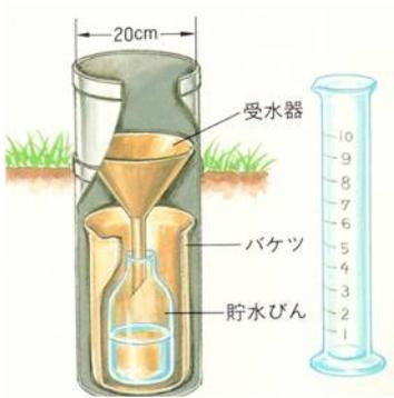
雨粒の直径は1mm～2mmくらいです。雨量は左のような(29…測定器の名前)に雨を受けて、集めた雨の量を(30…測定器の名前)で測ります。
