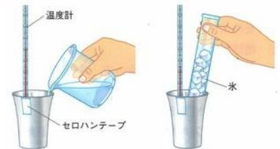
金属製のコップに水と氷を入れて水の温度を徐々に下げていくと、コップの外側に水滴が付き始めます。
