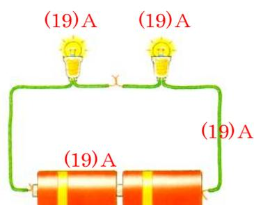
$(17)E$  の電圧が、全体の抵抗  $= (18)R$  にかかっていますから、全てに  $(19)A$  の同じ電流が流れています。
