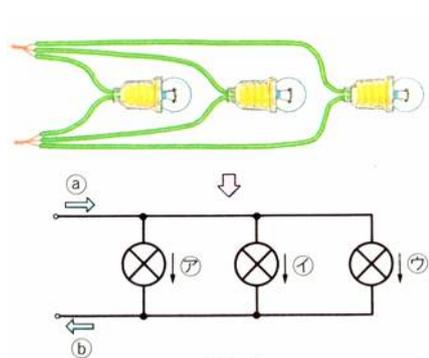
**確認** 1個の豆電球に  $1E$  ずつの電圧がかかっているため、それぞれの豆電球には  $1A$  ずつの電流が流れます。そして、㉗点と㉙点には3個の豆電球に流れている電流が集まるため  $(8)A$  になり、全体の抵抗は  $(9)R$  になるのです。いきなり、㉗点または㉙点に流れる電流を出すときは、
