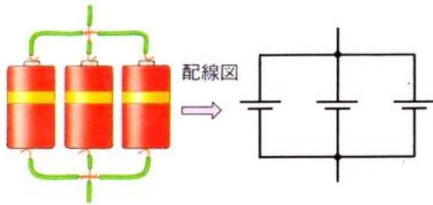
乾電池が2個・3個と並列つなぎになっても、電圧は  $1E$  のまま変わりません。しかし、それぞれが全電流を分担して流すようになるため、電池は1個のときよりも長持ちします。
