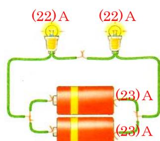
$(20)E$  の電圧が全体の抵抗  $= (21)R$  にかかっていますから、豆電球には  $(22)A$  の同じ大きさの電流が流れ、乾電池はそれぞれが  $(23)A$  の電流を流しています。
