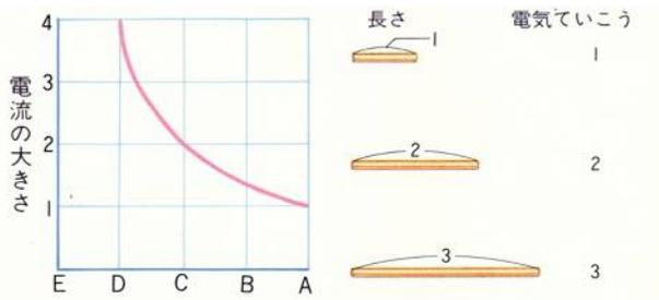
抵抗の長さが2倍・3倍になると、抵抗も2倍・3倍になります。左は電流の大きさと抵抗の大きさの関係を表した反比例のグラフです。抵抗が5倍になったため、電流は(44)倍になっています。
