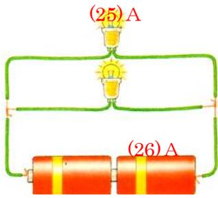
1個の豆電球には(24)Eの電圧がかかっていますから、1個の豆電球には(25)Aの電流が流れ、全体では(26)Aが流れています。乾電池は(26)Aの電流を流し、全抵抗は(27)Rです。
