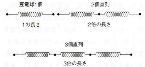
○電流を  $1E \div 1R = 1A$  としたとき、下の配線図の抵抗と電流の大きさを数字で答えなさい。
