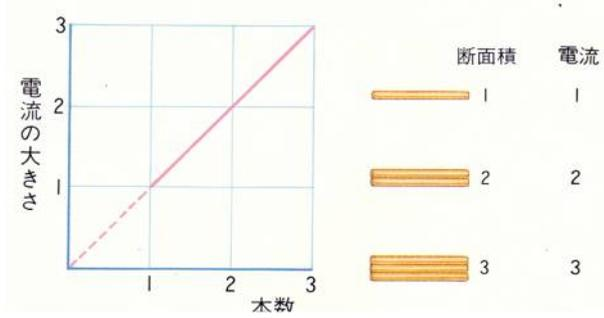
また、断面積が2倍・3倍になると、抵抗は $1/2$ 倍・ $1/3$ 倍になります。左は電流の大きさと導線の本数をあらわした(正)比例の関係を表したグラフです。導線を並列に2本・3本とつなぐことで断面積が増え、抵抗が $1/2$ 倍・ $1/3$ 倍と減っています。
