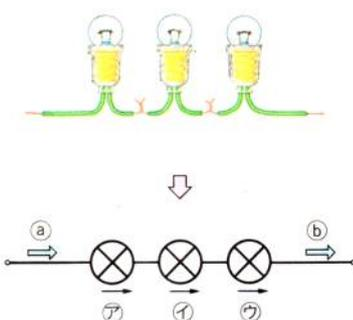
**確認** 直列つなぎの電流の通り道は1つだけのため、3個の豆電球の両端に乾電池1個分の  $1E$  の電圧がかかっています。そのため、それぞれの豆電球には、 $1/3E$  ずつの電圧しかかからず、1個の豆電球に流れる電流は  $1/3A$  になります。そして、3個の豆電球の抵抗はすべて同じ大きさのため、それぞれに  $1/3A$  の同じ電流が流れるのです。
