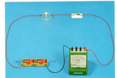
電流計は導線(コイル)に流す電流の大きさによって、磁力が変化することを利用してつくられています。そのため、電流計は必ず回路に(52…直列か並列で)につなぐことや、赤い方の(53…+か-)の端子から電流を入れることなどの注意が必要です。これと反対に、電圧計は回路に(54…直列か並列で)につなぎます。
