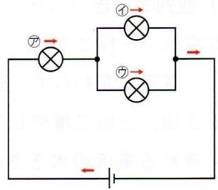
全体は直列回路です。直列回路は1本の通り道しかないため、どちらにも同じ電流が流れています。このときの㉗の抵抗と(㉘+㉙)の全抵抗の比は  $2 : 1$  です。そこに同じ大きさの電流を流すため、電圧の比も  $2 : 1$  なのです。
