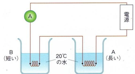
直列つなぎのため、同じ電流が流れています。そのため、抵抗が大きいAの方に多くの電圧がかかり、その電圧の比は温度上昇を見ると(7...?:?)と分かります。これより、抵抗の比も同じで、6分後の水温は(8)°C・(9)°Cと分かります。
