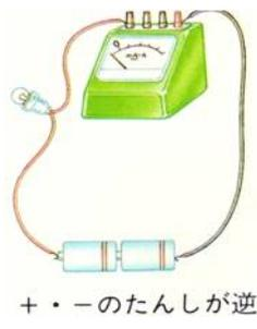
もし、電流計を並列につないだら、回路は(55…短絡のこと)してしまいます。電流計の電気抵抗は無視できるくらいに小さくつくってあるためです。また、乾電池の+と-を逆につなぐと針が左にふれて、電流計をこわしてしまいます。
