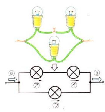
この回路では、㉗+㉘の両端と、㉙の両端に  $1E$  ずつの電圧がかかっているため、㉗の電流=㉘の電流= $(10)A$  の電流が流れています。
