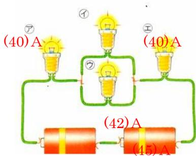
抵抗の比は(38...?:?:?)のため、㊸にかかる電圧は(39...分数で)Eです。㊸と㊹には(40)Aの同じ大きさの電流が流れ、㊺と㊻には(41)Aずつの電流が流れています。乾電池1個には(42)Aの電流が流れています。全抵抗は(43)Rです。
