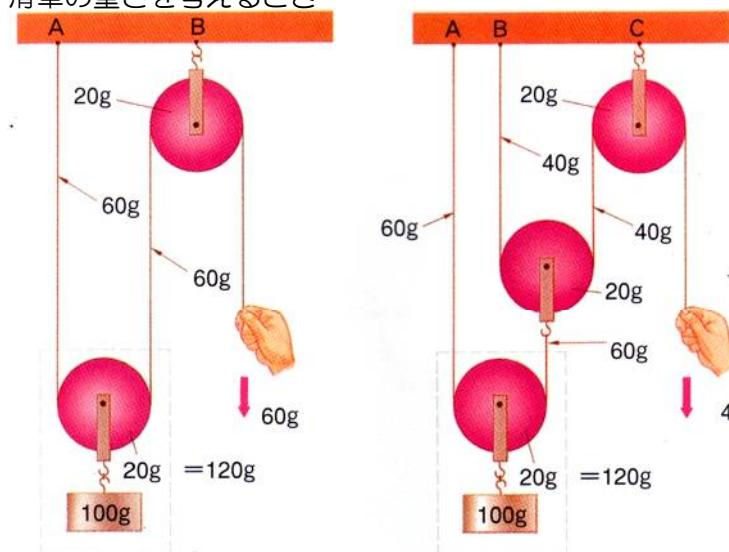
滑車に重さがあるときは、滑車の重さを足して求めます。図17では、A=(19) g B=(20) gとなり、下向きの力=おもりの重さ+手で引く力+滑車の重さ=(21) g
