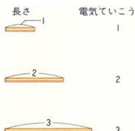
抵抗の長さが2倍・3倍になると、抵抗も2倍・3倍になります。左は電流の大きさと抵抗の大きさの関係を表した反比例のグラフです。
