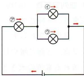
全体は直列回路です。直列回路は1本の通り道しかないので、どちらにも同じ電流が流れています。このときの⑦の抵抗と⑧ + ⑨の全抵抗の比は  $2 : 1$  です。そこに同じ大きさの電流を流すため、電圧の比も  $2 : 1$  なのです。つまり、⑦には  $2/3 E$  の電圧がかかり、⑧と⑨には  $1/3 E$  ずつの電圧がかかります。そのため、⑦には  $(13)A$  の電流が流れ、⑧の電流 = ⑨の電流 =  $(14)A$  です。つまり、⑦の電流 = ⑧ + ⑨の電流になります。
