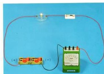
電流計は導線(コイル)に流す電流の大きさによって、磁力が変化することを利用してつくられています。そのため、電流計は必ず回路に(52…直列か並列で)につなぐことや、赤い方の(53…+かーで)の端子から電流を入れることなどの注意が必要です。これと反対に、電圧計は回路に(54…直列か並列で)につなぎます。
