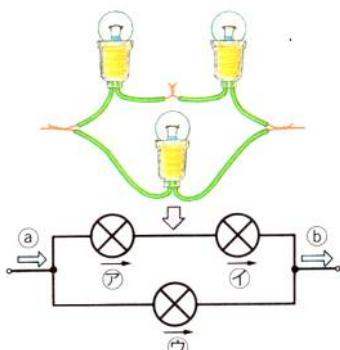
この回路では、④ + ⑤の両端と、⑥の両端に  $1E$  ずつの電圧がかかっているため、④の電流 = ⑤の電流 =  $(10)A$  の電流が流れています。
