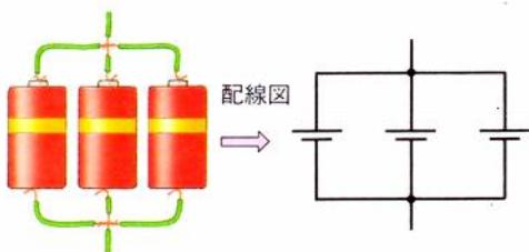
乾電池が2個・3個と並列つなぎになっても、電圧は $1E$ のまま変わりません。しかし、それが全電流を分担して流すようになるため、電池は1個のときよりも長持ちします。左では電圧 $=1E$ のままで。しかし、1個の乾電池 $\frac{1}{3}$ ずつしか流していません。
