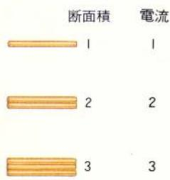
また、断面積が2倍・3倍になると、抵抗は $1/2$ 倍・ $1/3$ 倍になります。左は電流の大きさと導線の本数をあらわした(正)比例の関係を表したグラフです。導線を並列に2本・3本つなぐことで断面積が増え、抵抗が $1/2$ 倍・ $1/3$ 倍と減っています。
