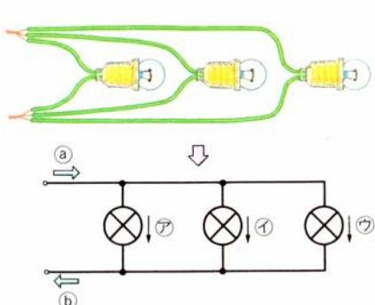
**確認** 1個の豆電球に  $1E$  ずつの電圧がかかっているため、それぞれの豆電球には  $1A$  ずつの電流が流れます。そして、④点と⑤点には3個の豆電球に流れている電流が集まるため  $(8)A$  になり、全体の抵抗は  $(9)R$  になるのです。いきなり、④点または⑤点に流れる電流を出すときは、 $1E \div (9)R = (8)A$  で求めます。
