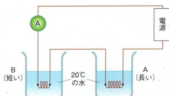
直列つなぎのため、同じ電流が流れています。そのため、抵抗が大きいAの方に多くの電圧がかかり、その電圧の比は温度上昇を見ると(7…? : ?で)と分かります。これより、抵抗の比も同じで、6分後の水温は(8)℃・(9)℃と分かります。
