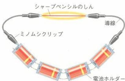
シャープペンシルの芯も光を出しますが、あまり明るくなりません。ニッケルとクロムの合金のニクロムも、電気エネルギーを光よりも熱にかえやすい性質をもっているため、電熱線として使われています。
